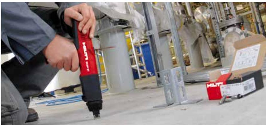
Sistemas de fijación directa simples para materiales como concreto, acero, bloques de mampostería. Presiona, gatilla y dispara. Sistemas de seguridad protegen al usuario y al medio ambiente. La nueva generación de cartuchos Clean – Tec garantizan una seguridad superior haciendo una combustión limpia incluso mejor que antes.
