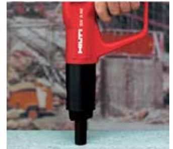
El **principio de seguridad de disparo accidental** previene que la herramienta sea accionada si se presiona el gatillo y después, se presiona la herramienta contra el material base. La herramienta por consiguiente, solo se puede accionar si primero se presiona ésta contra el material base, y después se presiona el gatillo.
