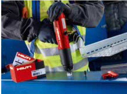
La DX 351-BT y el perno X-BT en vez de soldadura. Un sistema más rápido, portátil y seguro. Evita daños en la estructura, y puede ser usado en cualquier ambiente.
